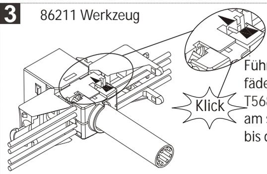
Führen Sie alle Adern durch die Abdeckung und fädeln diese in die korrekten Aussparungen nach T568A oder T568B. Richten Sie die Abdeckung am schwarzen Dreieck aus und drücken Sie, bis die Abdeckung einrastet.
