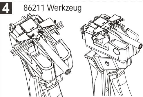
Benutzen Sie das 86211 Werkzeug um gleichzeitig alle Adern zu kontaktieren und die Enden abzuschneiden.
