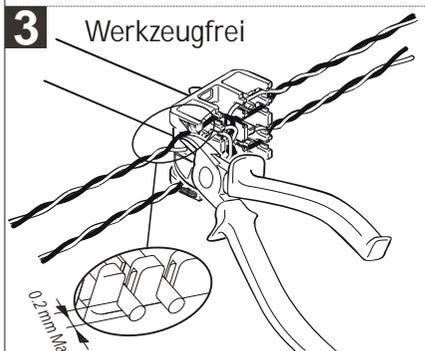
Führen Sie alle Adern durch die Abdeckung und fädeln diese in die korrekten Aussparungen nach T568A oder T568B. Schneiden Sie die Adern an der Abdeckung ab. Die Adern sollten danach nicht länger als 0,2 mm sein.
