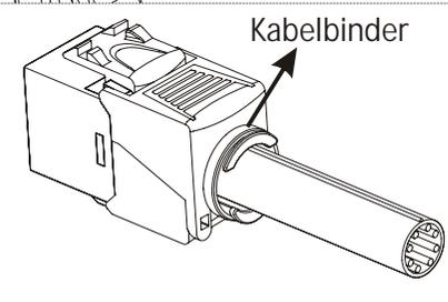
Wickeln Sie den Schirmungsdraht um das geschirmte Ende und schließen es mit einem Kabelbinder.
